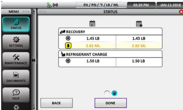
Los valores en el lado izquierdo de la pantalla mostrarán la última cantidad de refrigerante recuperado, refrigerante cargado y aceite inyectado. Los valores en el lado derecho de la pantalla muestran los totales de por vida del refrigerante recuperado, el refrigerante cargado y el aceite inyectado.
